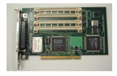
TLAser400 PCI (no modules installed).
